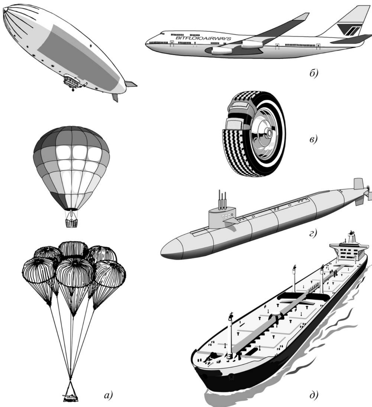
Рис. 26. Применение оболочек в технике. Оболочки, работающие под внутренним давлением: мягкая – а) дирижабль, воздушный шар, купол парашюта системы десантирования); б) жесткая (герметичный фюзеляж самолета); в) многослойная армированная (бескамерная шина); з) оболочки под внешним давлением (прочный корпус подводной лодки); д) сложная подкрепленная оболочка (относительно небольшое внешнее давление, знакопеременные изгиб и кручение – корпус и грузовые отсеки судна-сухогруза)
