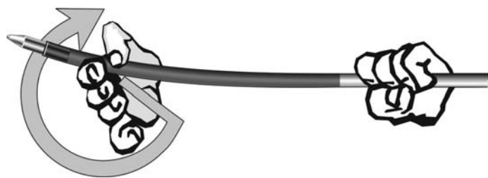
Рис. 47. Простой опыт по определению положения сжатых волокон
